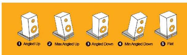
**angled up** زاویه بالا که در حالت عادی با لایه اول پنل یک شیب 10 درجه به سمت بالا به وجود می آید و با استفاده از لایه دوم به صورت بر عکس 10 درجه به شیب اضافه میشود
