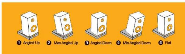
**angled up** زاویه بالا که در حالت عادی با لایه اول پنل یک شیب 10 درجه به سمت بالا به وجود می آید و با استفاده از لایه دوم به صورت برعکس 10 درجه به شیب اضافه میشود **angled down** زاویه پایین که با چرخش 180 درجه پد به صورت افقی زاویه مانیتور ها را میتوان به سمت پایین تغییر دارد که معمولاً در زمان قرار گرفتن مانیتور روی سه پایه و میز کنسول های 2 طبقه قابل استفاده می باشد
